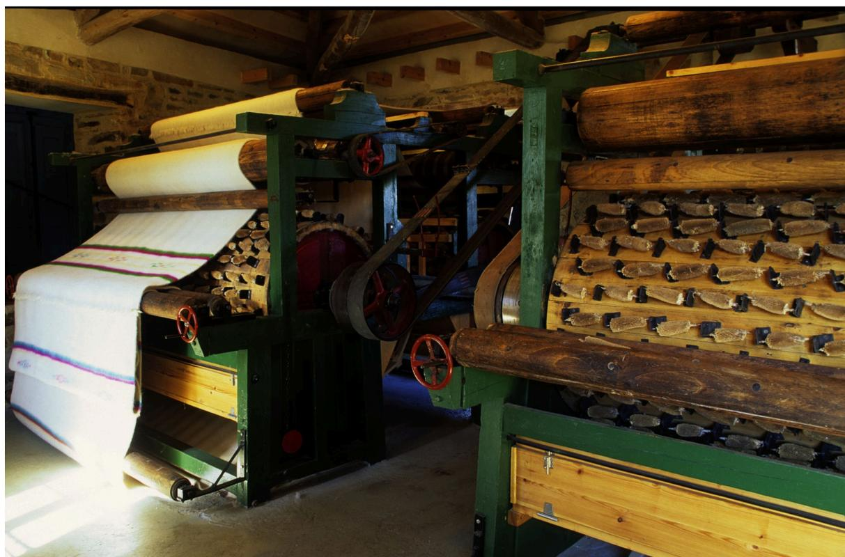
Ancien bâtiment qui était déjà destiné à fouler les draps et les couvertures en 1920. Il possédait deux foulons mobiles actionnés par la force hydraulique. A l'extérieur du bâtiment, l'eau des canaux faisaient bouger les maillets. Par la suite, les maillets du foulon commencèrent à être actionnés à l'énergie électrique.
